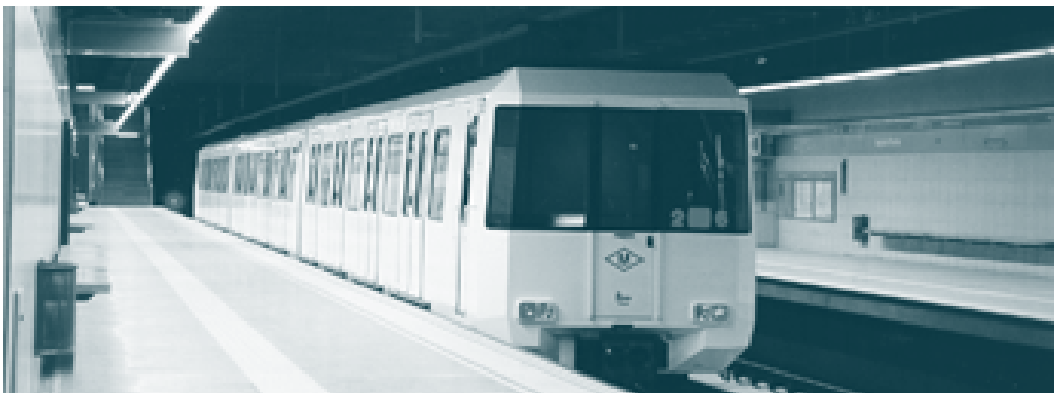
Convoy del metro de Barcelona Sistema 2000 de la línea 2 fabricado por ALSTOM y equipado con onduladores de potencia tipo Onix que lo convierte en uno de los más modernos del mundo
