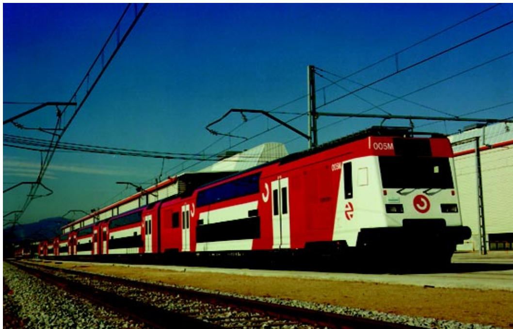
Unidad 450 de dos pisos fabricada por ALSTOM y CAF para el servicio de cercanías. Estos trenes de dos pisos permiten que por una misma superficie la capacidad de transporte en asientos sea entre un 50-60 % superior y entre un 40-50 % en carga total.
