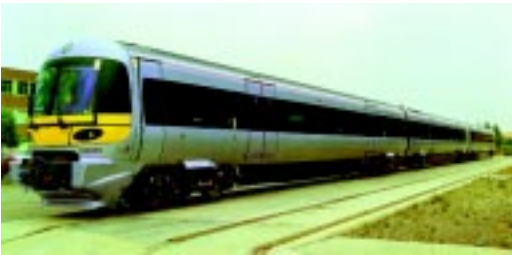
Moderno tren eléctrico con motor asíncrono trifásico a 400 voltios de 6 pulsos contruido por CAF para la línea del aeropuerto de Londres para alcanzar una velocidad de 160 km/h en ruta.
