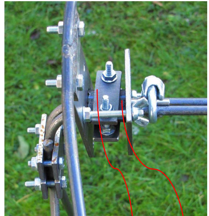
Vista de embrague de fricción en el eje con placa de cojinete, placa de presión, anillo de fricción (13) y sujetador del anillo de fricción (14)
