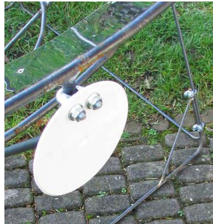
Indicador de sombra (22) fijado a conector central de anillo con abrazadera (20); disco blanco en un plano vertical al plano del anillo principal
