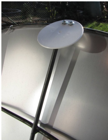
Vista de la conexión del eje (4) con puntal vertical (2), embrague de fricción, placa de cojinete (11)
